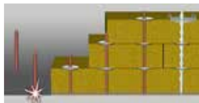
Монтаж сварочных шипов
